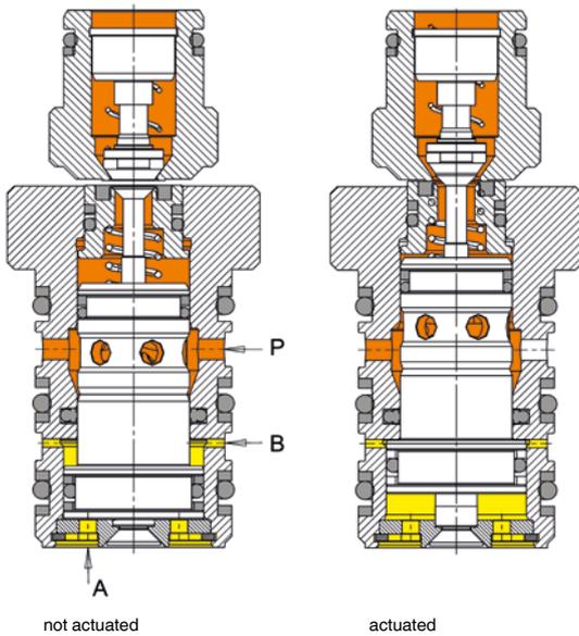
1. Raccord de commande B : mécanisme d'accouplement en position de base
