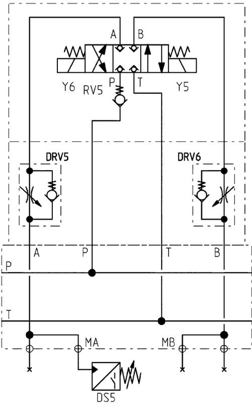
Plaques rehaussées avec fonction de soupape d'étranglement pouvant être connectée sur P
